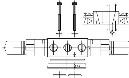
\* Normalmente a válvula simples é fornecida com a placa de interface 5/2 vias, para obter a configuração 3/2 vias NF, girar a placa 180°.
